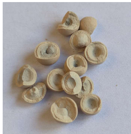
Рис. 4. Пошкодженні гранули цеоліту 5А
