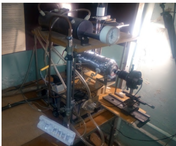
Рис. 1. Фото і схема установки: 1 - підвіс; 2 - пневматичний подаючий пристрій з мікрогвинтами; 3 - горизонтальна піч з електричним нагрівальним елементом; 4 - відеокамера Hardity IC - 490; 5 - мікроскоп; 6 - поляризаційний фільтр; 7 - освітлювач; 8 - датчик виміру температури (хромель-алюмелева термопара); 9 - вакуумний насос; 10 - оглядові вікна; 11 - вакуумна посудина; 12 - демпферна посудина; 13 - манометр; 14 - реле тиску; 15 - компресор; 16 - комп'ютер; 17 - потенціометр; 18-23 - замочні крани, 24 - витратомір
