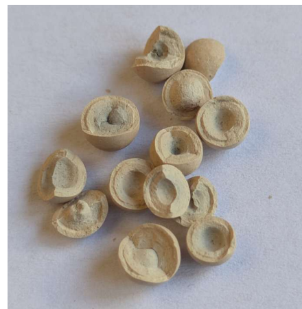
Рис. 4. Пошкодженні гранули цеоліту 5А
