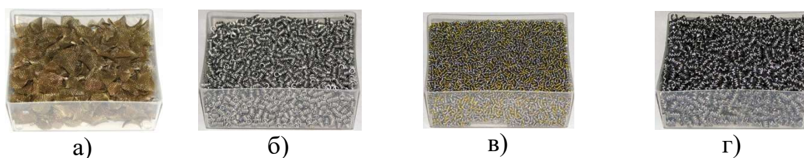
Рис.3. Типи нерегулярних масообмінних елементів ректифікаційних колон [12]: а) – сітлоподібні сітчасті; б); в) – спіральні циліндричні; г) – спіральнопризматичні
