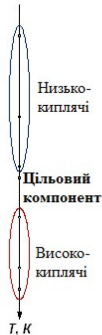
Рис.2. Принцип вилучення цільового компонента з багатокомпонентної суміші [10]
