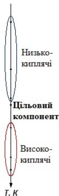
Рис.2. Принцип вилучення цільового компонента з багатокомпонентної суміші [10]
