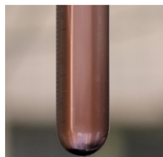
Рис. 8. Зображення зразку мастила Planetelf ACD 100 FY з вмістом 0,5 мас. % C_{60} через 1 рік зберігання (більша частина C_{60} в осаді)
