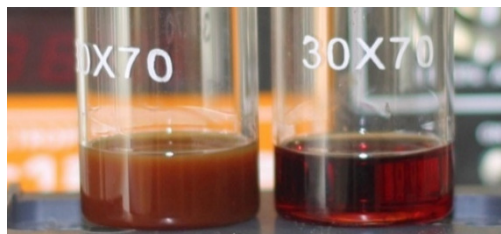
Рис. 1. Мاستило ХФ16-12 з вмістом 0.5 мас. % C_{60} (ліве) та 0.13 мас. % C_{60} (праве) після зберігання протягом 2 місяців
