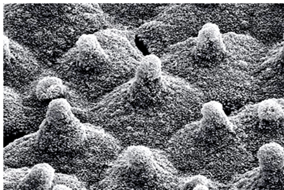
Рис.4. Зображення поверхні листка лотоса у растровому електронному мікроскопі, \times 1500
