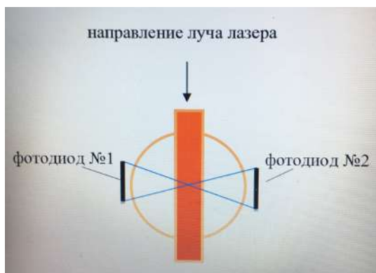
Рис. 4. Схема измерительного объема счётчика аэрозольных частиц ИЗ-124
