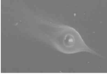
Рис.3. Смещение частиц КДФ около ВЧ меди в сильном электростатическом поле при осаждении на плоскую твёрдую поверхность.
