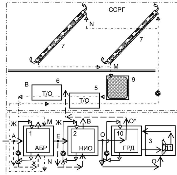
**Рис. 2.** Принципиальная схема солнечной системы кондиционирования воздуха ССКВ на основе открытого абсорбционного цикла с прямой регенерацией абсорбента. Подача в помещение охлажденной воды и обработанного воздуха.
