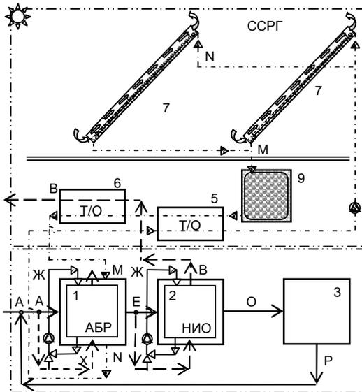
**Рис. 1.** Принципиальная схема солнечной системы кондиционирования воздуха ССКВ на основе открытого абсорбционного цикла с прямой регенерацией абсорбента. Подача в помещение воздуха, прошедшего термовлажностную обработку.
